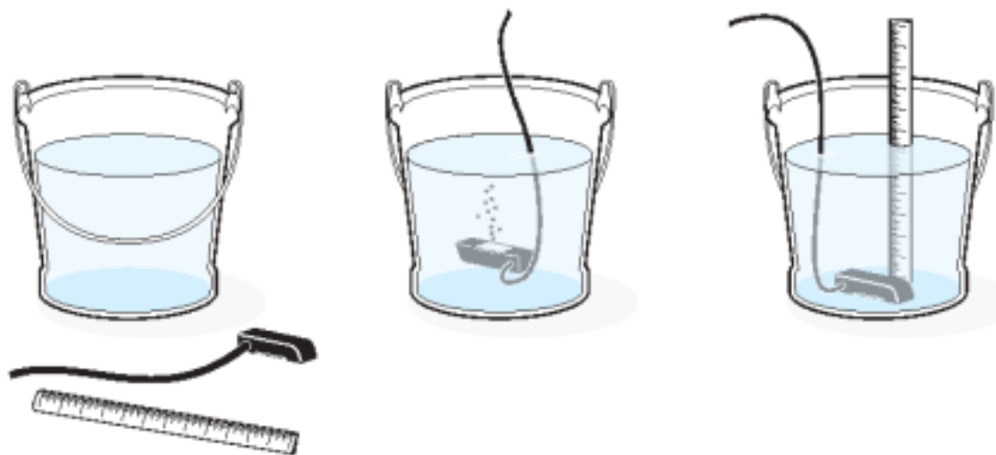
图 18 校准浸入式面积/速率传感器
